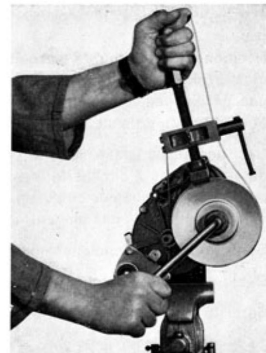
Fig. 10 — Déblocage de l'écrou de poulie.
