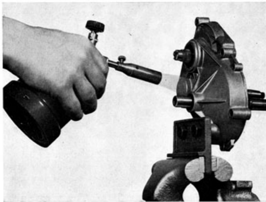
Fig. 22 — Chauffage autour de l'emplacement du roulement de l'arbre primaire.
