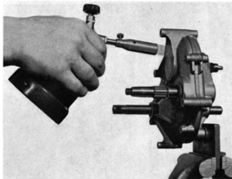
Fig. 18 — Chauffage autour de l'emplacement du roulement 20135 de l'arbre secondaire.
