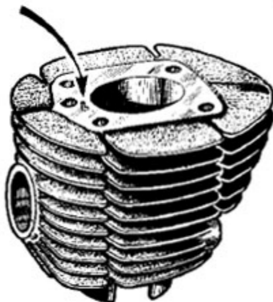
Emplacement du repère sur le cylindre
