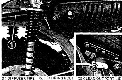
(1) DIFFUSER PIPE (2) SECURING BOLT
