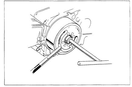
FLYWHEEL REMOVAL TOOL FLYWHEEL PULLER 07933-0010000
