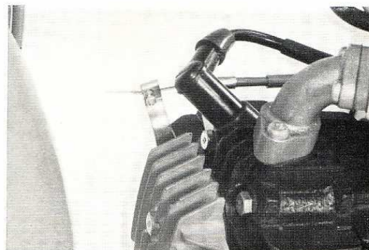
Fig. 47. — REGLAGE DU LEVIER DE DECOMPRESSION.
