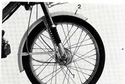
Fig. 19. — DEMONTAGE DU GARDE-BOUE AVANT.
