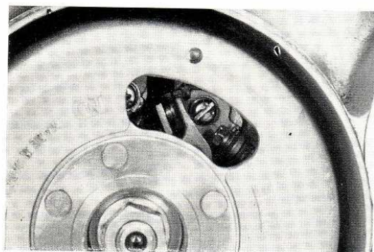
Fig. 43. — METHODE DU REGLAGE DU POINT D'ALLUMAGE.
