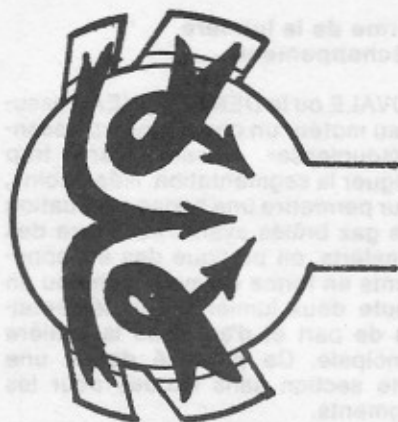
Figure 2 Balayage SCHNURLE dédoublé.
