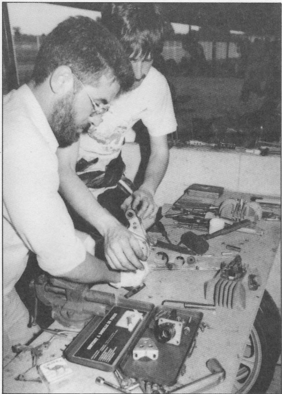
Photo 5 Deux mécanos lors des 24h du Mans ouvrent les carters d'un XG2 103.
